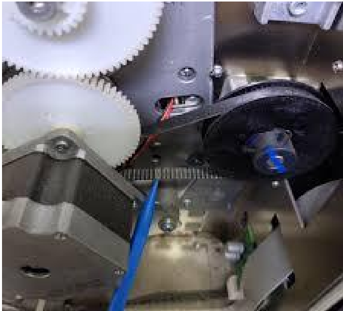
Falhas iniciais na correia, causando o não tracionamento no motor.
